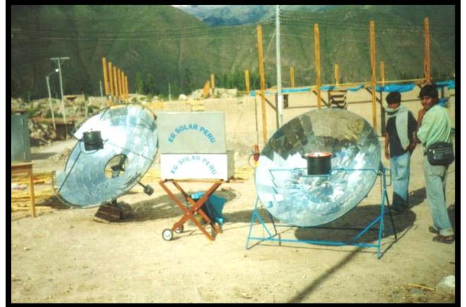
Fig. : Uso de energías renovables: calentadores, hornos y cocinas solares
