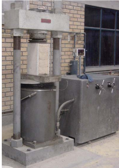
Figura 2 Ensayo de resistencia a la compresión en panel tierra-concreto
