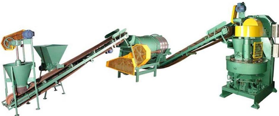
Fig. 2 – Sistema integrado para produção de tijolos de solo-cimento constituído por dosador de terra, dosador de cimento, esteira, misturador e prensa. Figura obtida no *site* da empresa ([http:// www.man.com.br](http://www.man.com.br))
