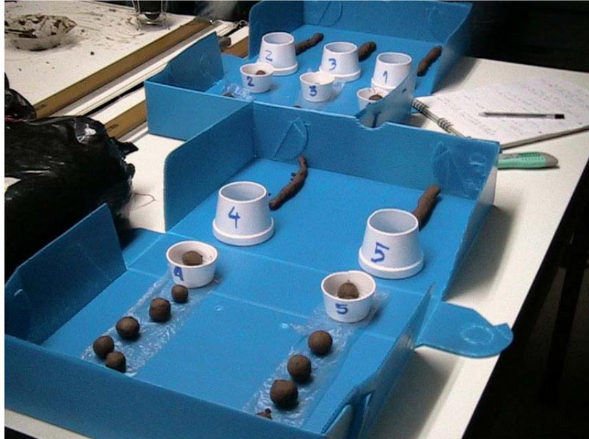
Figura 1 – Probetas con tierra de Santiago del Estero
