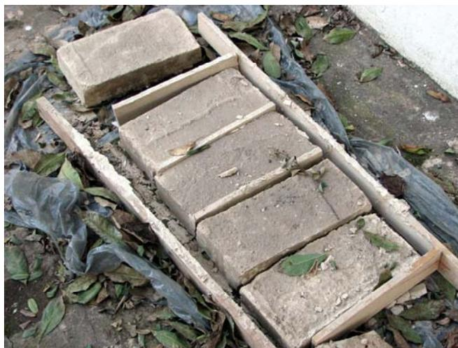
Figura 3 – Prototipo de ladrillos de adobe estabilizado
