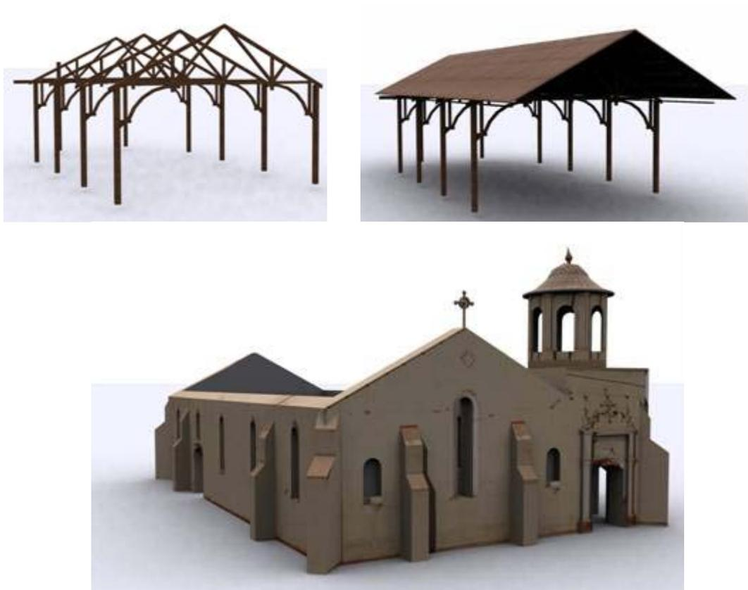
**Figura 17** – Esquemas tridimensionales de estructura iglesia. Fuente: Oficina Surtierra arquitectura
