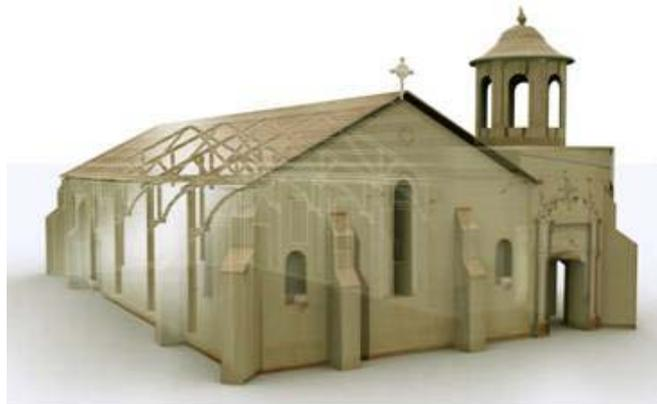
**Figura 18** – Síntesis estructura Iglesia. Maqueta virtual elaborada por Surtierra arquitectura
