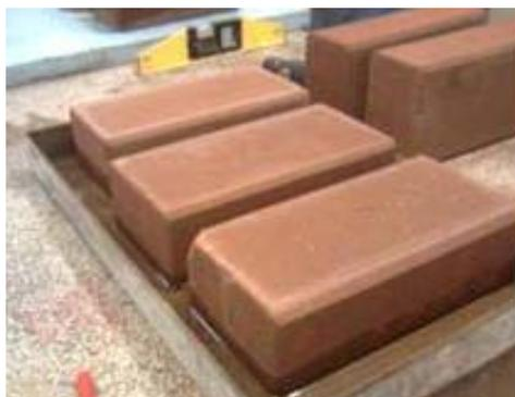
**Figura 4 – Aspecto dos pisos com RCD**
