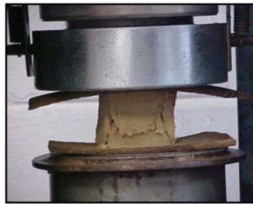
**Figura 8** – Ensayo de compresión
