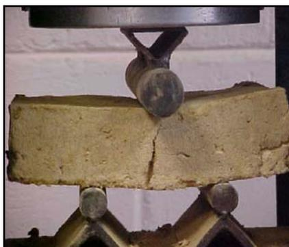
**Figura 9** – Ensayo de flexión
