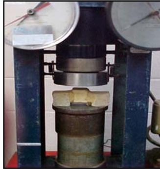
Figura 10 – Ensayo de adherencia
