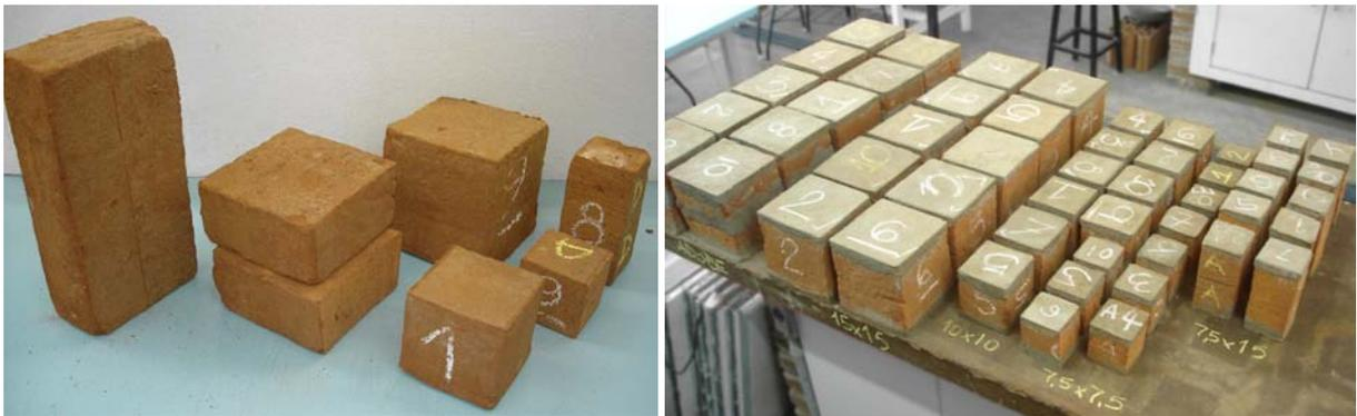
Figura 4 – Corpos-de-prova preparados, antes da ruptura.
