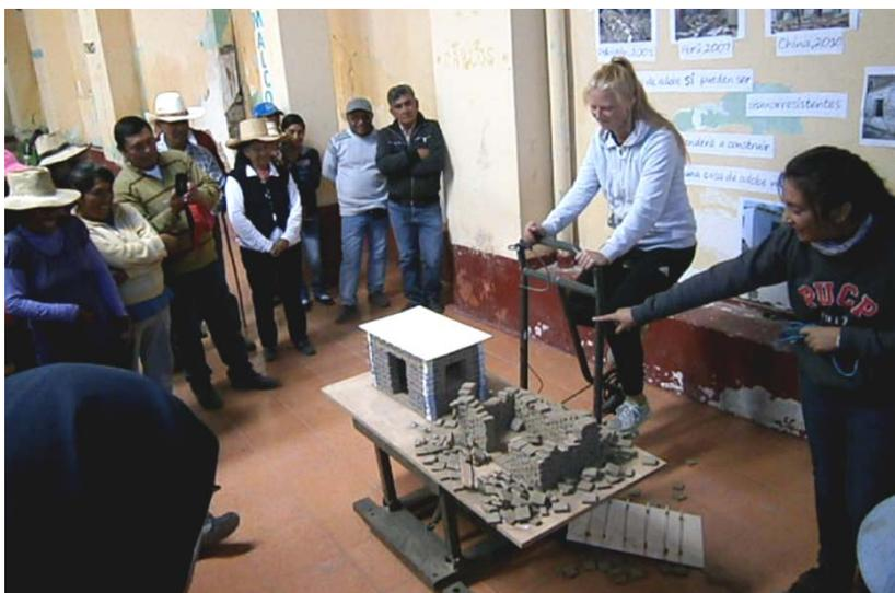
Figura 6. Demostración con la mesa vibratoria portátil PUCP
