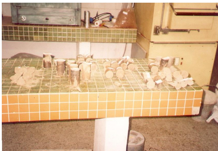
Fig. 3 Muestras ensayadas a la compresión en laboratorio
