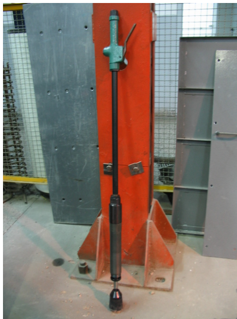
Figura 1. Equipo de apisonado automático (García; Nigro; Mazzeo, 2007)
