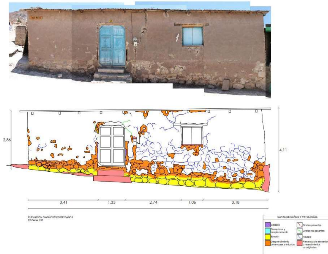
Figura 4. Lámina con diagnóstico de daños previo a la liberación de revoques (Fundación Altiplano)
