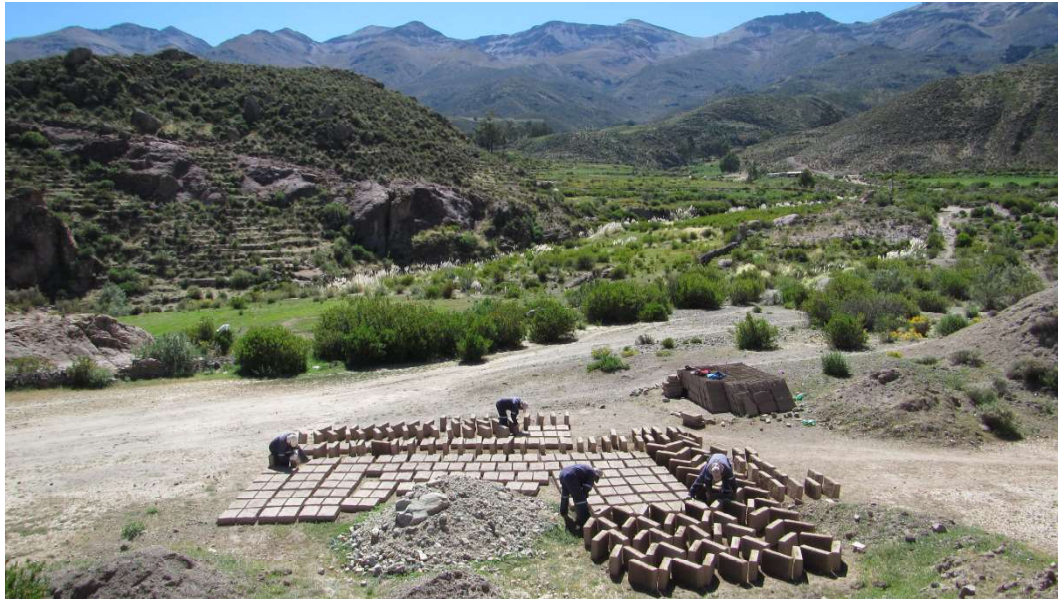
Figura 6. Secado de adobes fabricados
