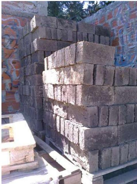
Figura 6. Acopio de los adobes sobre pallets de madera
