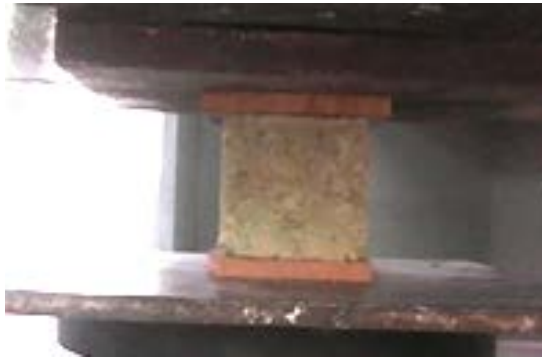
Figura 4. Ensayo de resistencia a la compresión
