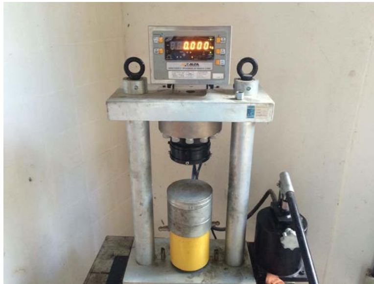
Figura 2. Máquina para o ensaio de resistência à compressão
