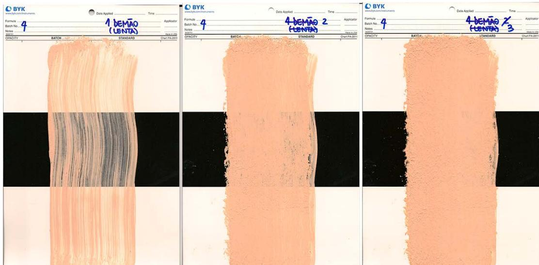
Figura 1. Imagens escaneadas da mesma cartela obtidas a cada demão de tinta aplicada.
