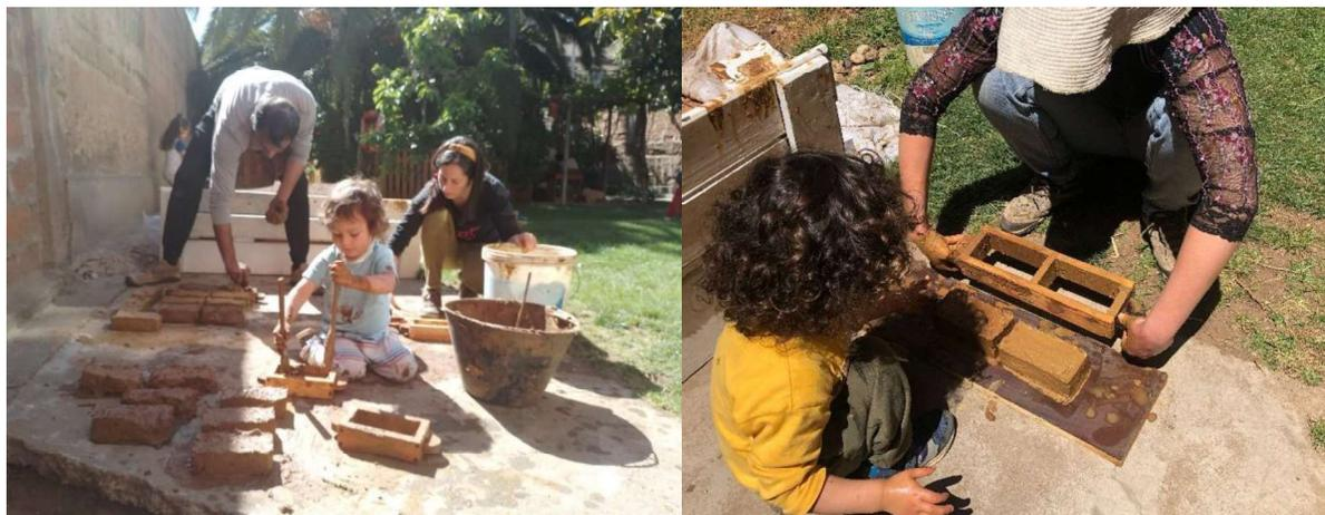
Figura 6. Fabricación de adobitos por medio de molde diseñado a escala
