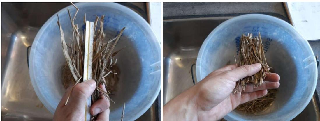
Figura 3. Medição e corte das fibras de capim-braquiária
