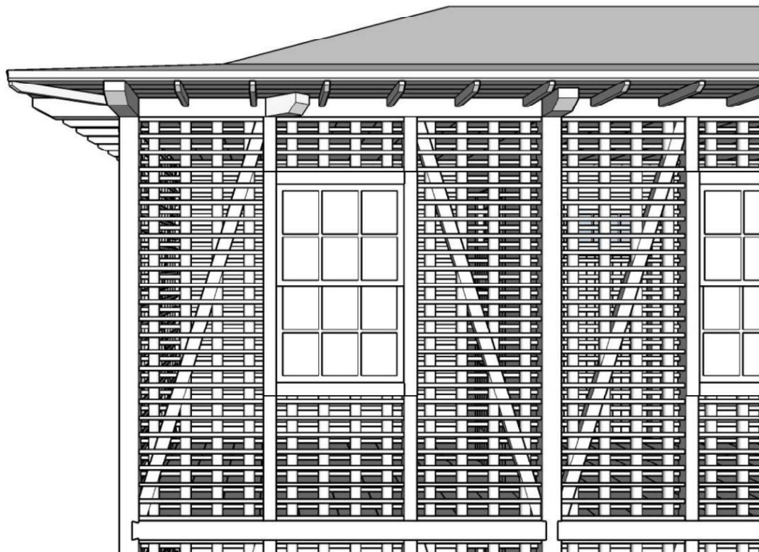
Figura 2. Representação das varas fixadas nos paus a pique
