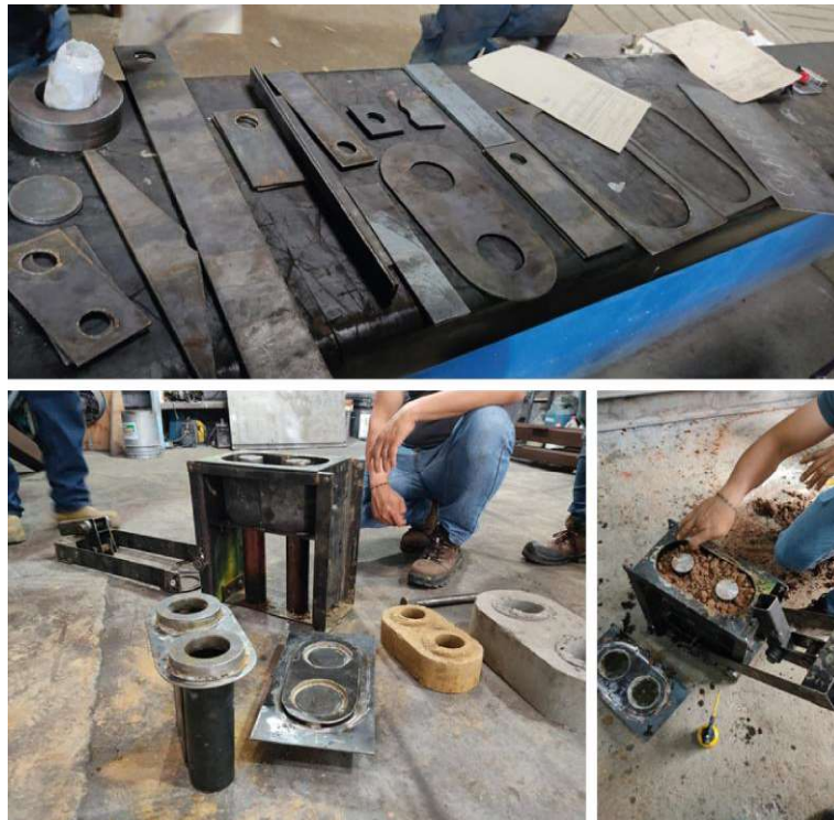
Figura 2. Piezas de máquina cortadas en láser
