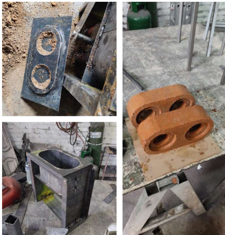
Figura 3. Nuevo molde para BTC
