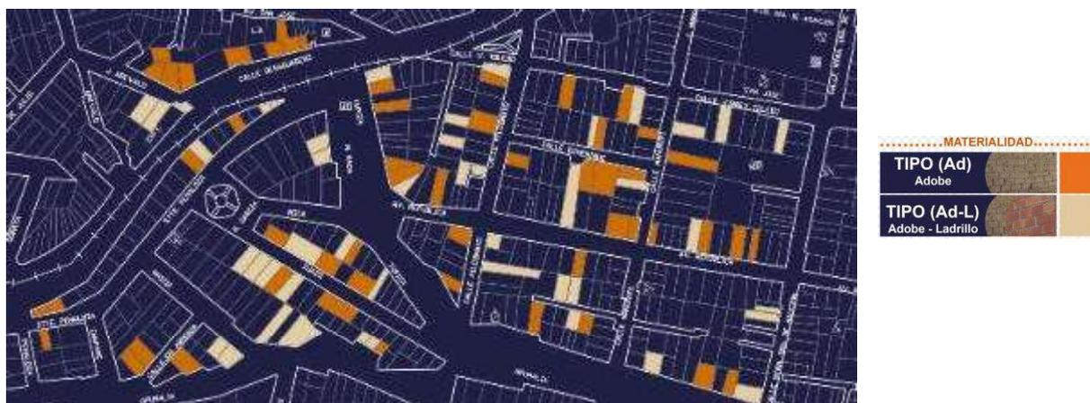
Figura 3. Planimetría del relevamiento de viviendas construidas con tierra
