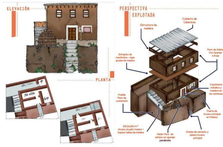
Figura 7. (izquierdo) Dibujo digital de la elevación y planta; (derecha) Perspectiva explotada del modelo de vivienda 2-LP en Villa Victoria
