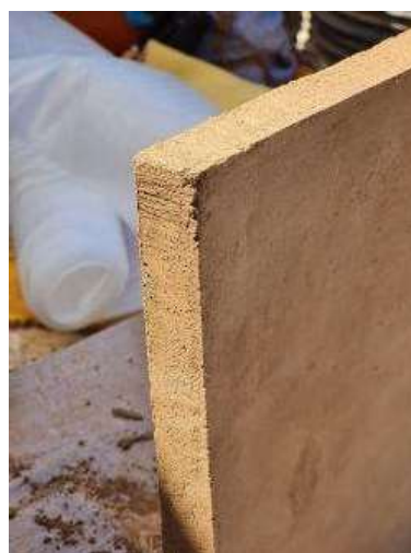
Figura 16. Estado final probeta revoque fino
