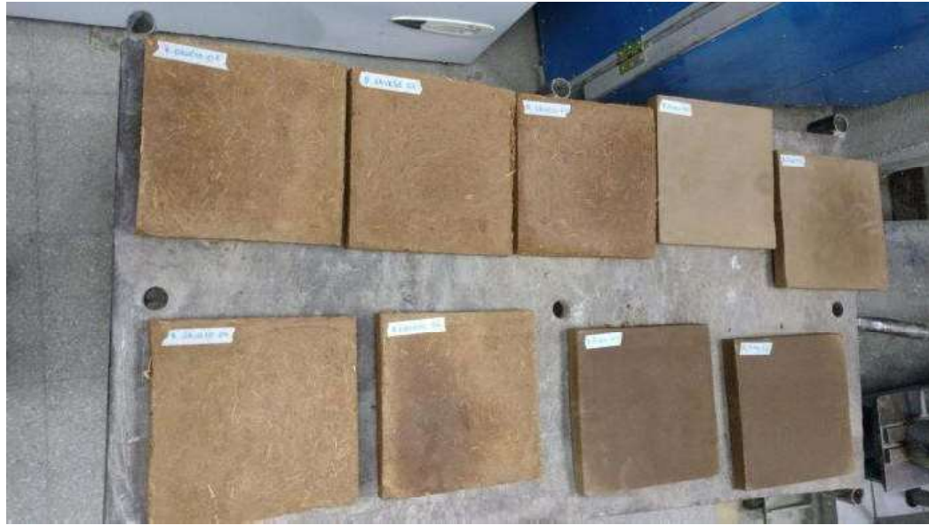
Figura 18. Probetas revoque grueso y fino. Foto de los autores
