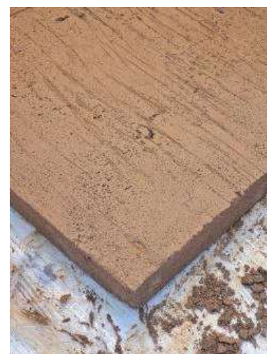
Figura 17. Estado final probeta revoque fino
