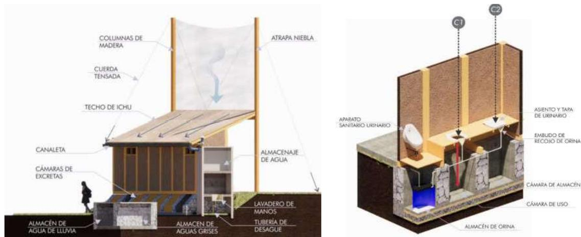
Figura 6. Esquema general del sistema y funcionamiento del módulo de baño seco
