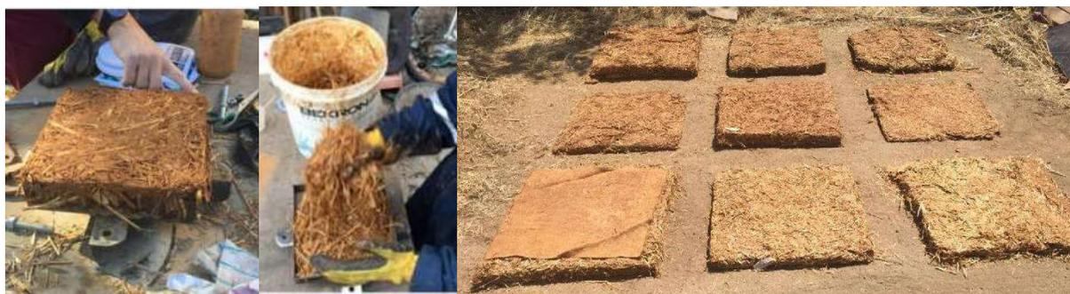
Figura 8 – Imágenes del proceso de integración de fibra vegetal en las probetas
