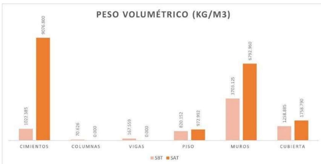
Figura 5. Datos comparativos de peso volumétrico
