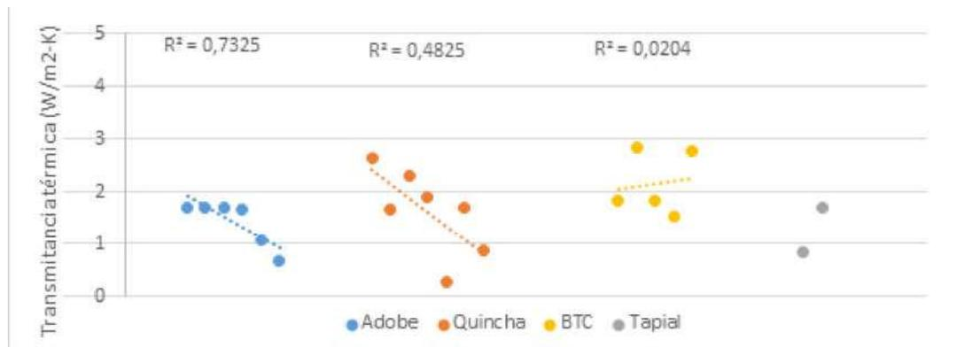
Figura 3. Transmitancia térmica según el sistema constructivo
