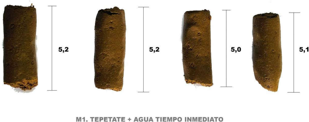
Figura 1. Ensayo de cohesividad; intervalo de tiempo inmediato
