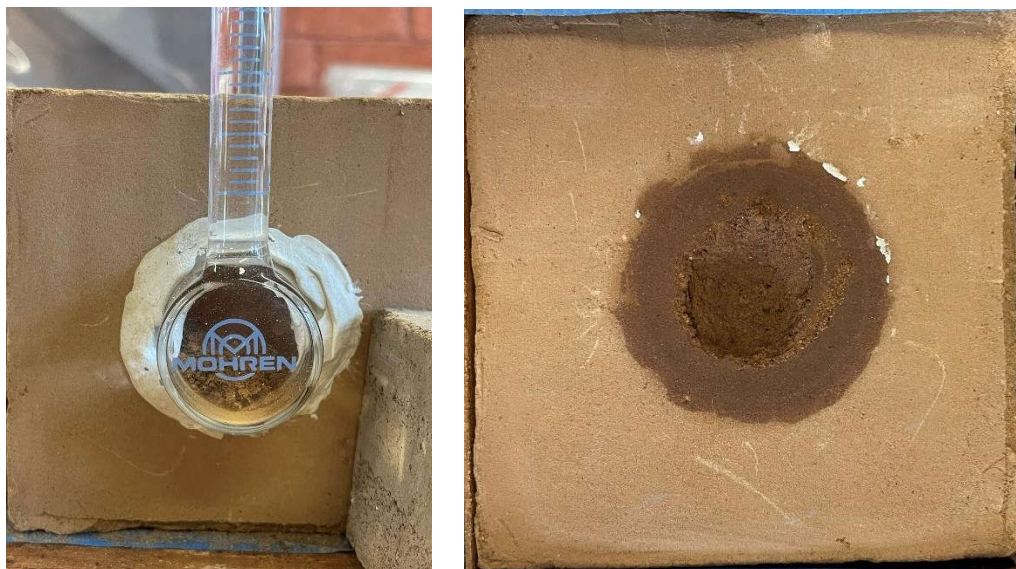
Figura 8. Ensayo de absorción capilar por método de la pipeta; intervalo de una semana
