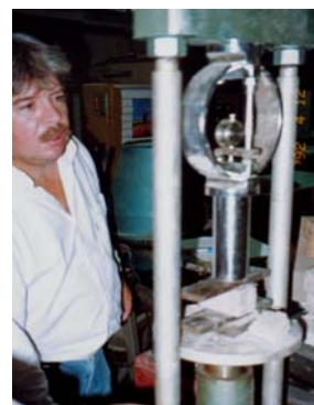
Figura 11: Ensayo de corte sobre probetas (5x5x14) cm.
