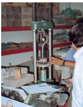
Figura 9: Ensayo de compresión sobre probetas (5x5x14) cm.
