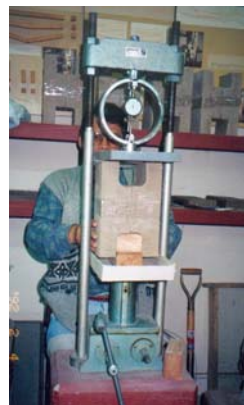
Figuras 14 -15 y 16: Ensayo de Corte Bloques articulados BaTc-II: Orientación de la fractura en cuerpo central.
