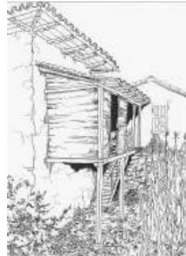
Figura 5. Azuay, Gualaceo. Extensión de la vivienda a través de adaptación de estructura de madera.
