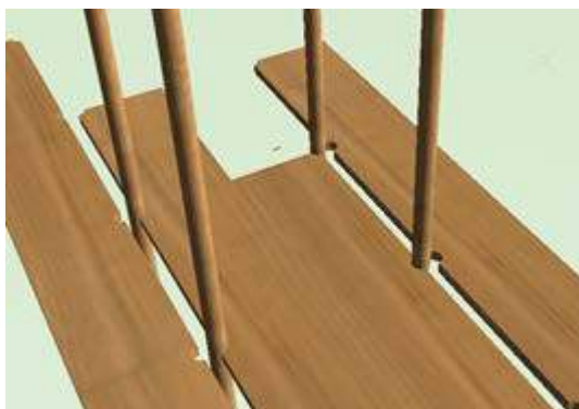
Figura 12. Calce de postes y plataforma CLT
