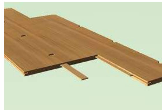
Figura 13. Lamelas de unión paneles CLT
