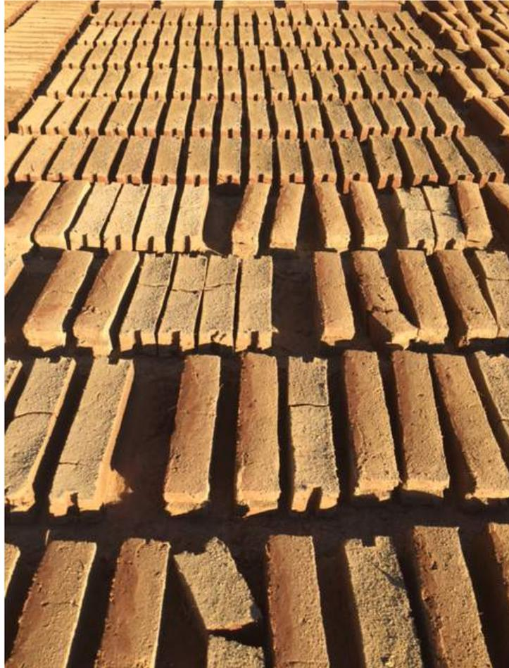
Figura 5. Secado de adobillos durante proceso de fabricación (Crédito: Álvaro Riquelme)
