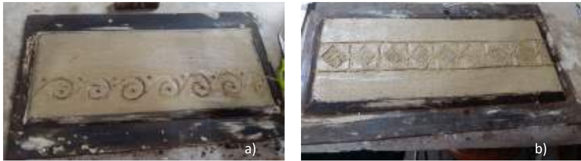
Figura 3. a) Muestra realizada a base de suelo, arena, cal y agua. b) Muestra con adición de fibra (Crédito: Monserrat Plaza)
