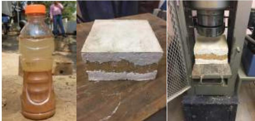
Figura 3 – Prueba de sedimentación en campo, preparación del cabeceo de muestra y ensayo de resistencia a la compresión en laboratorio
