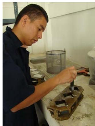
Figura 7. Moldeo de cubos de mortero
