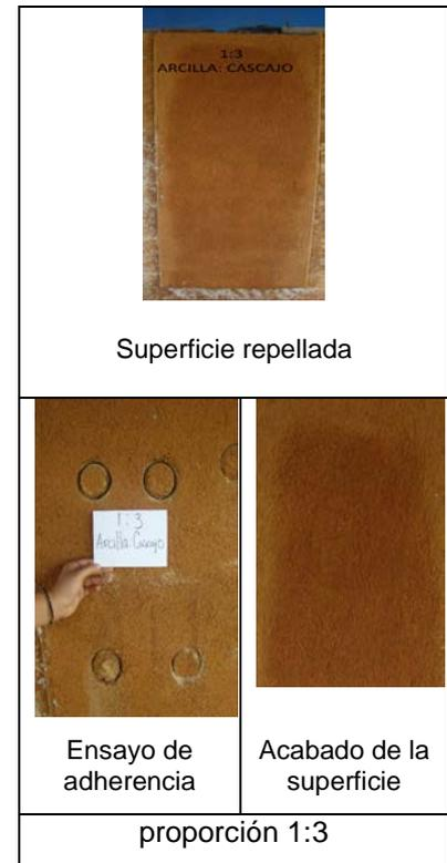
Figura 13. Aspecto del repello y ensayos del mortero de tierra y cascajo
