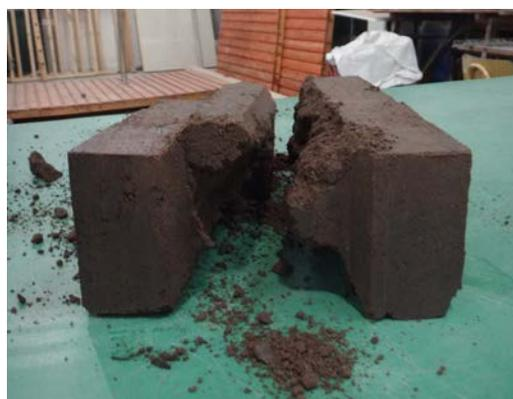
Figura 11. Rotura de bloque en el proceso de extracción
