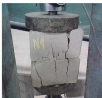
Figura 9. Probeta de BTC después del ensayo de la compresión
