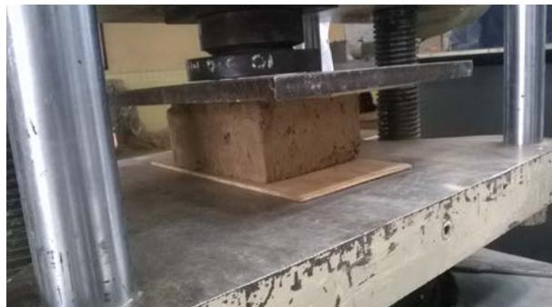
Figura 4. Ensayo a la compresión
