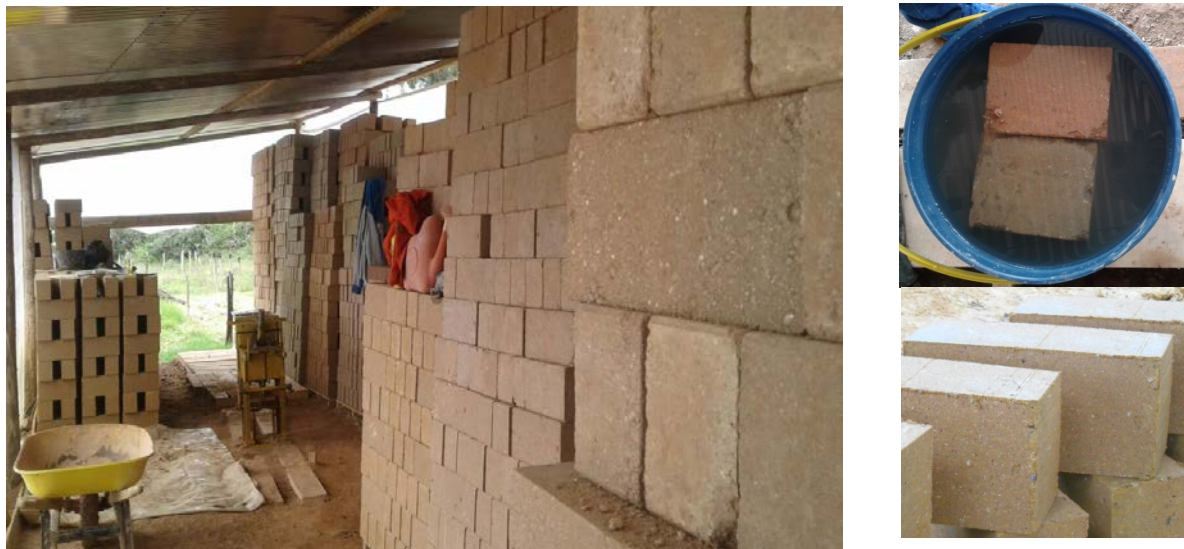
Figura 4 - Producción de bloques de tierra comprimidos y prueba con suelos locales para el eco hotel (crédito: L. Garzón, 2018)
