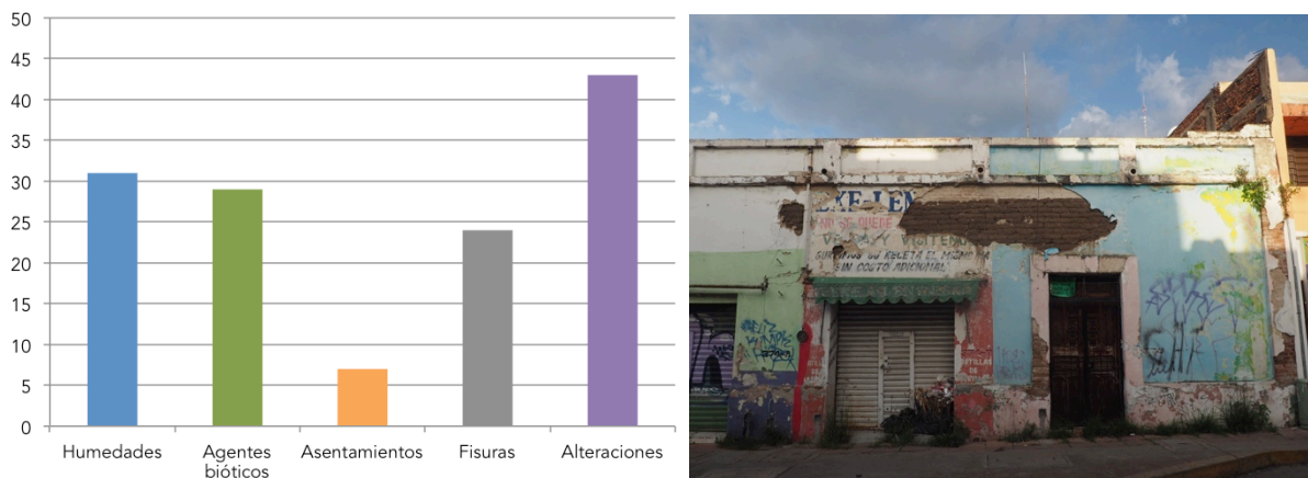
Figura 5. Gráfica de las lesiones patológicas de las edificaciones tradicionales en el Barrio Santo Domingo y ejemplo de las alteraciones presentes (crédito: A. Parra-Zebadúa)
