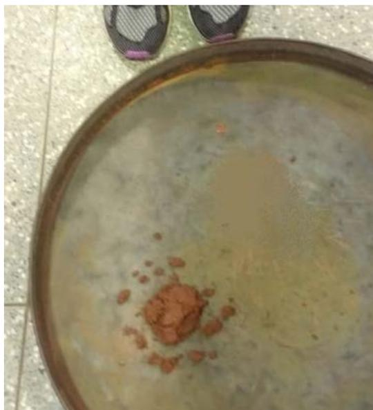
Figura 9: Resultado do teste de queda no teor de água ótimo
