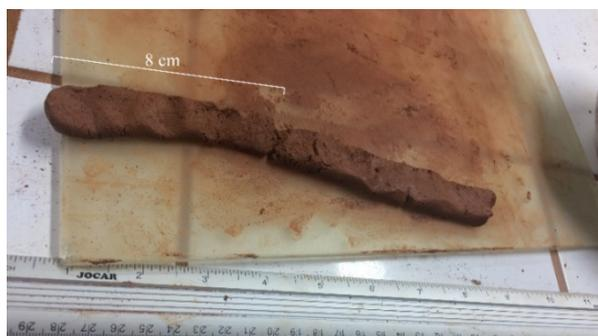
Figura 6: Aferição do comprimento do segmento rompido do ensaio de fita
