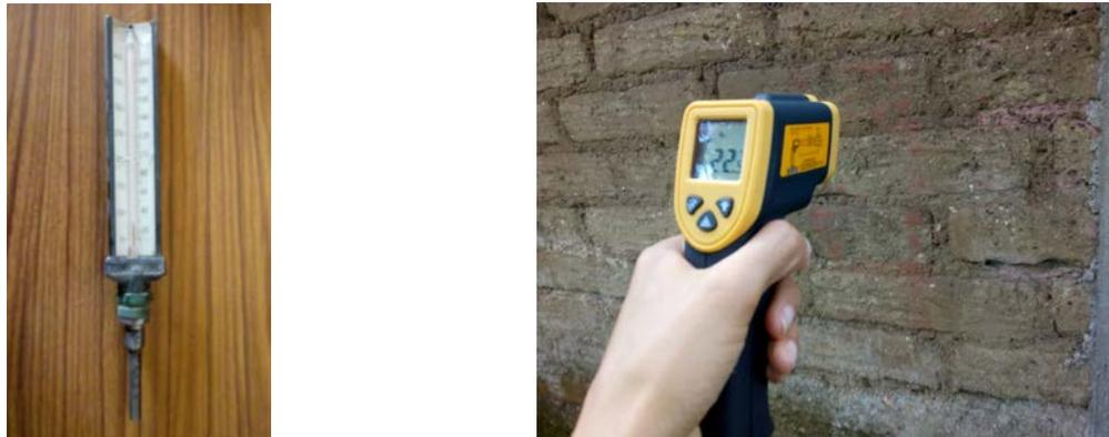
Figura 1. Termómetro ambiental y termómetro infrarrojo de superficie (toma datos temperatura °C)
