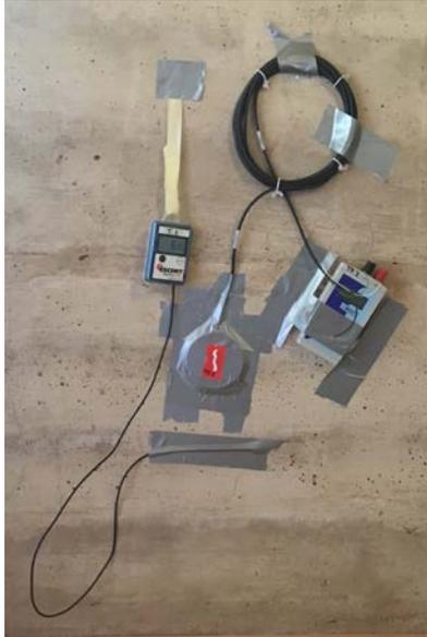
Figura 2. Instalación de equipos de medida en el muro estudiado (crédito: A. Castellarnau)
