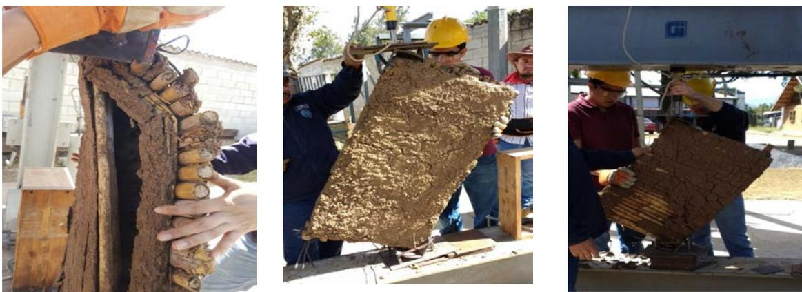
Figura 10. a) Falla del panel 1; b) Falla del panel 2; c) Falla del panel 3
