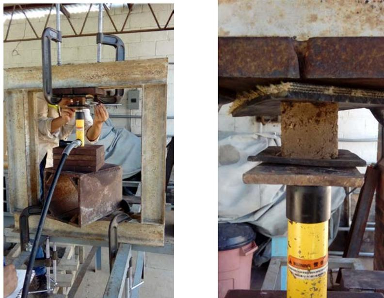
Figura 8. Aparato y detalle del ensayo a resistencia a compresión
