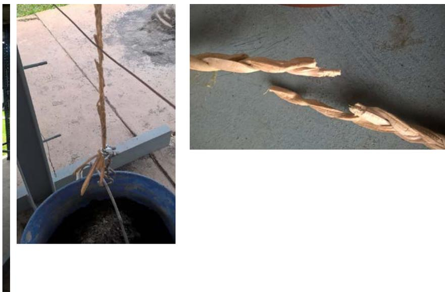
Figura 6. a) Sistema para determinar la resistencia a la tracción de fibra de tule; b) Equipo para aplicación de la carga a tracción; c) Falla de la fibra
