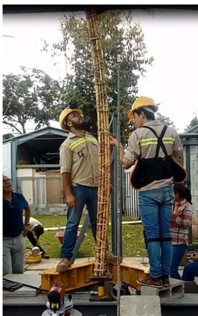
Figura 9. Ensayo a resistencia a compresión en columna
