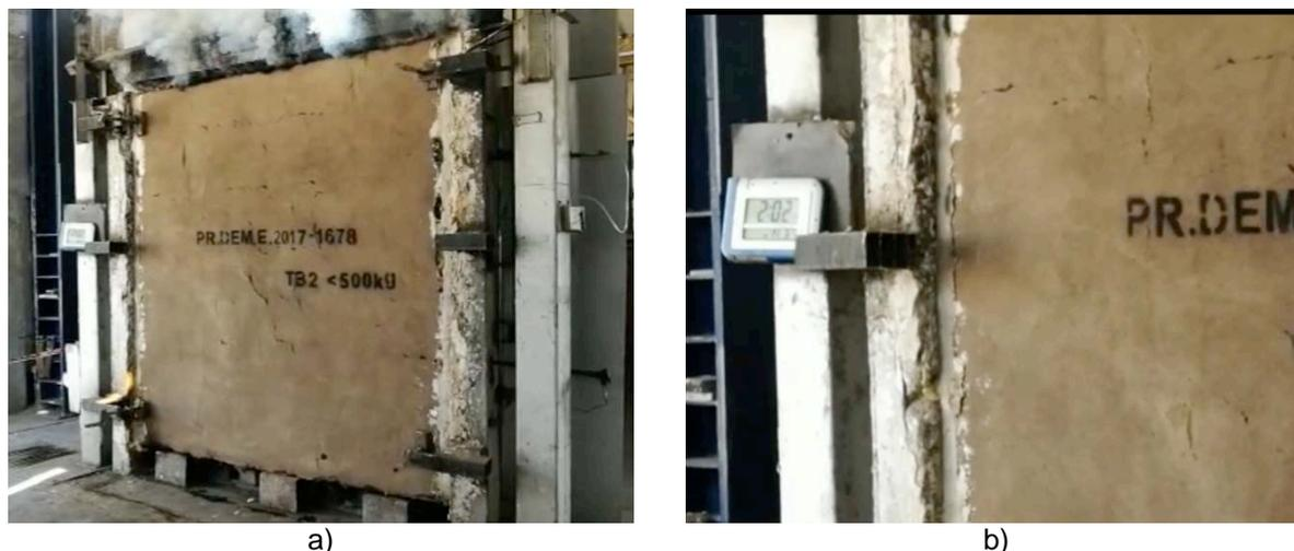
Figura 6. Imágenes del muro durante el ensayo. A la izquierda del muro se observa el cronómetro superando las 2 horas de ensayo (120 minutos)
