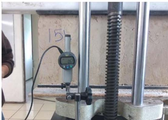
Figura 2. Deflectómetro para medición de deformaciones
