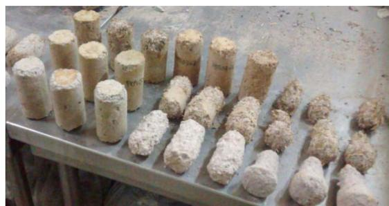
Figura 6. Probetas en la prueba de durabilidad mojado-secado en su quinceavo ciclo
