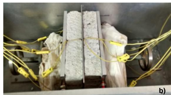
Figura 3. Ensayo de conductividad térmica: a) circuitos eléctricos del sistema de placa caliente (cotas en cm); b) termopares conectados
