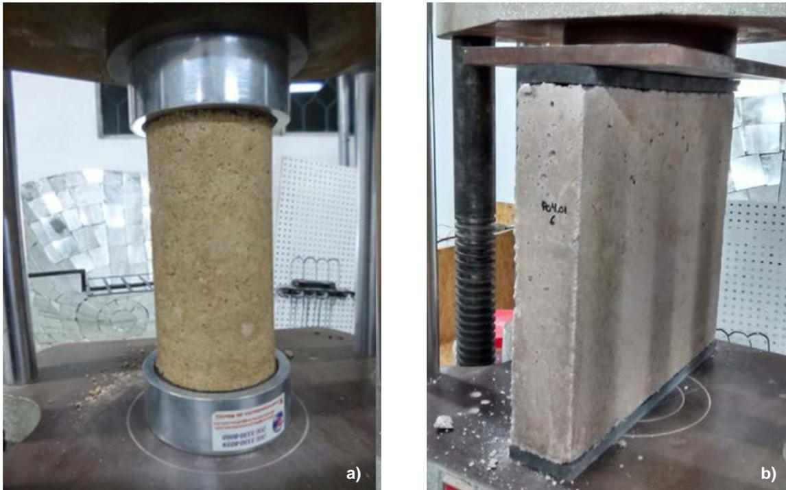
Figura 1. Probetas: a) cilindro para el ensayo de compresión; b) panel para el ensayo de flexo-compresión
