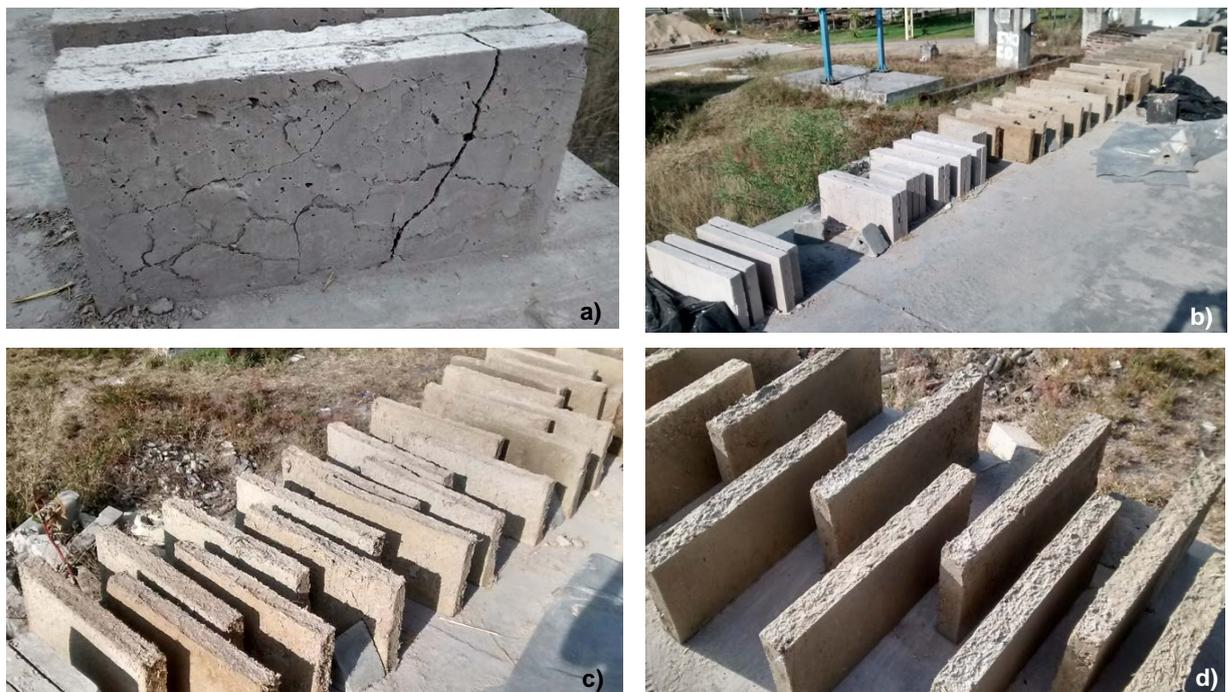
Figura 10. a) Panel PF0101 con fracturas y grietas por contracción/retracción; b) Paneles de la serie final PF, en proceso de secado y curado; c) Paneles PF0104 en proceso de secado y curado; d) Paneles PF0105 en proceso de secado y curado
