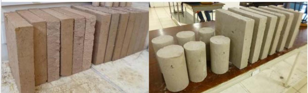
Figura 7. Probetas cilíndricas y paneles para las pruebas para la caracterización mecánica
