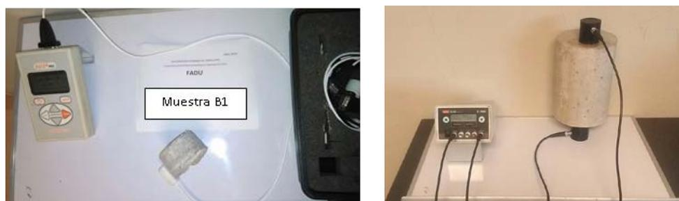
Figura 1. Representación de la toma de conductividad térmica (izquierda) y de pulso ultrasónico (derecha).
