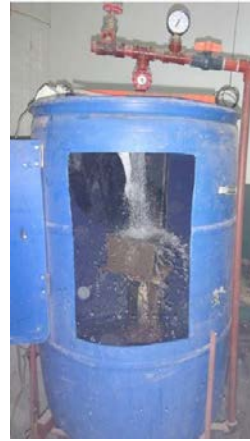
c) Figura 2: Ensayo de erosión por pulverizado de agua a presión (IS 1725, 1982)
