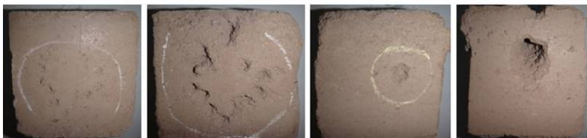
Figura 3: Registros fotográficos de probetas ensayadas a erosión húmeda por caída de agua SEAT y pulverizado de agua a presión
