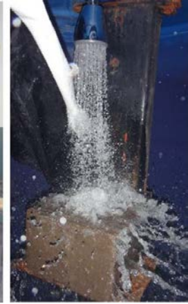
c) Figura 2: Ensayo de erosión por pulverizado de agua a presión (IS 1725, 1982)
