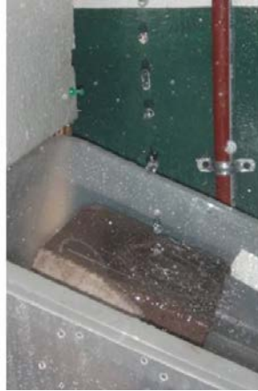
Figura 1: Ensayo de erosión acelerada por caída de agua (UNNE 4141, 2008)
