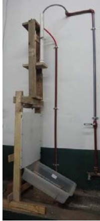
Figura 1: Ensayo de erosión acelerada por caída de agua (UNNE 4141, 2008)
