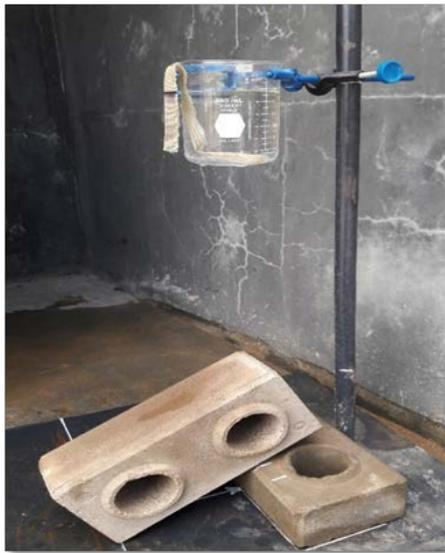
Figura 8. Ensayo de caída de agua, método Geelong
