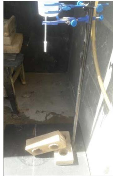
Figura 9. Ensayo de caída de agua, método SAET
