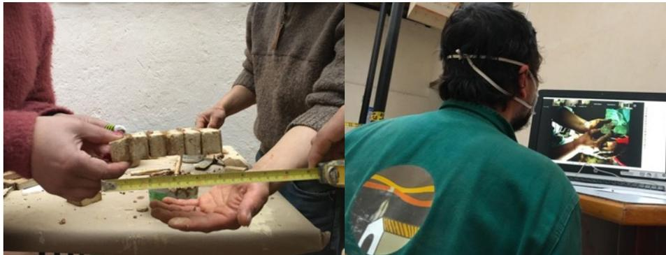
Figura 6. Aprendices constatando la cohesión de la arcilla en las tierras y realizando pruebas de campo en los talleres de “Bóvedas mexicanas” y de “Caracterización de tierras”
