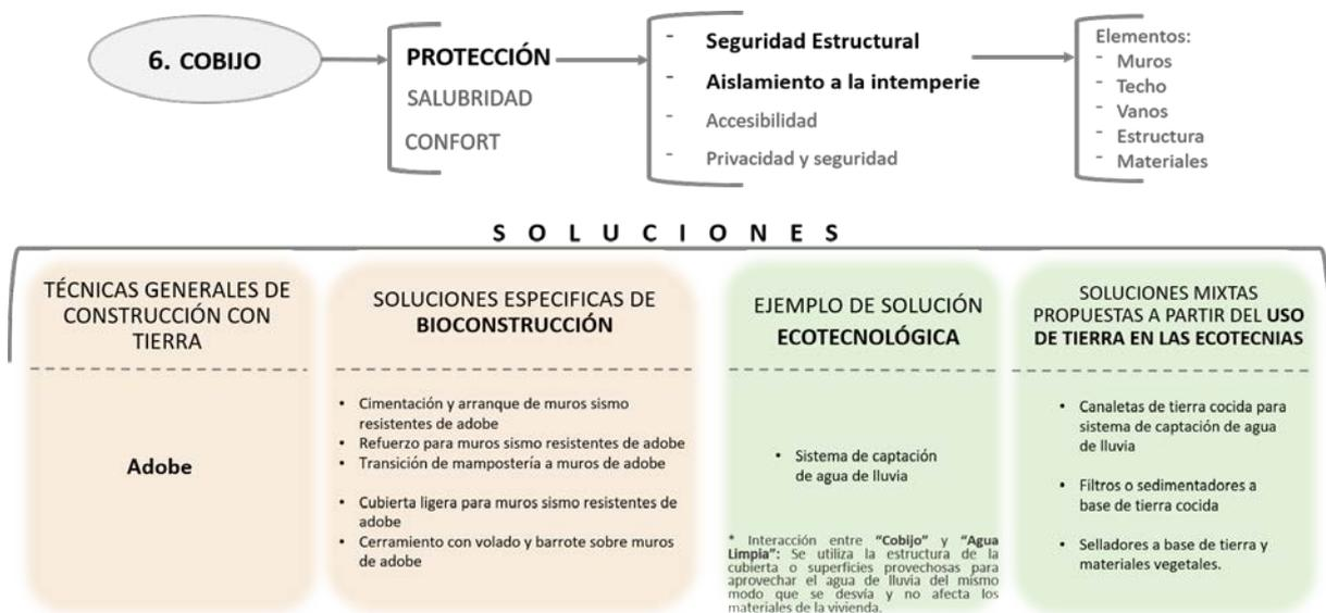
Figura 5. Simplificación del seguimiento en la Identificación y clasificación de soluciones en el eje de cobijo en relación con una técnica de construcción con tierra: Adobe (crédito: Navia, S.).
