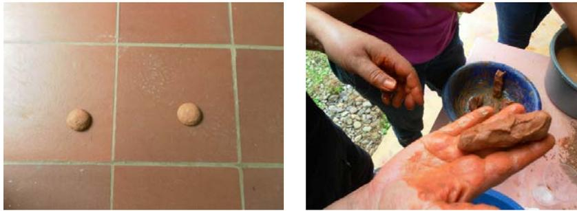
Figura 2. Ensayo de la bolita y del frotado
